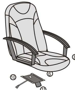
6. Сиденье установите отверстием в металлической площадке на газпатрон.
